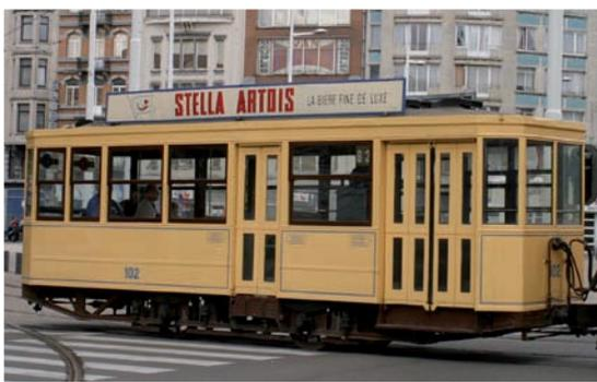
Ce tram, qui date de 1934, fait partie de la même série de motrices « standards » que la 1259. Après guerre, le confort de ces trams est encore sensiblement amélioré grâce au placement de portes, de chauffage, et d'un poste fixe pour le receveur.
