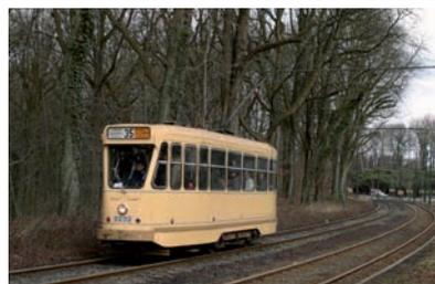
Ce tram a une allure faussement moderne. Sur ces petites motrices, seule la carrosserie date de 1960. Le châssis, les équipements électromécaniques et une grande partie de l'aménagement intérieur proviennent en effet de trams construits entre 1929 et 1933 !
