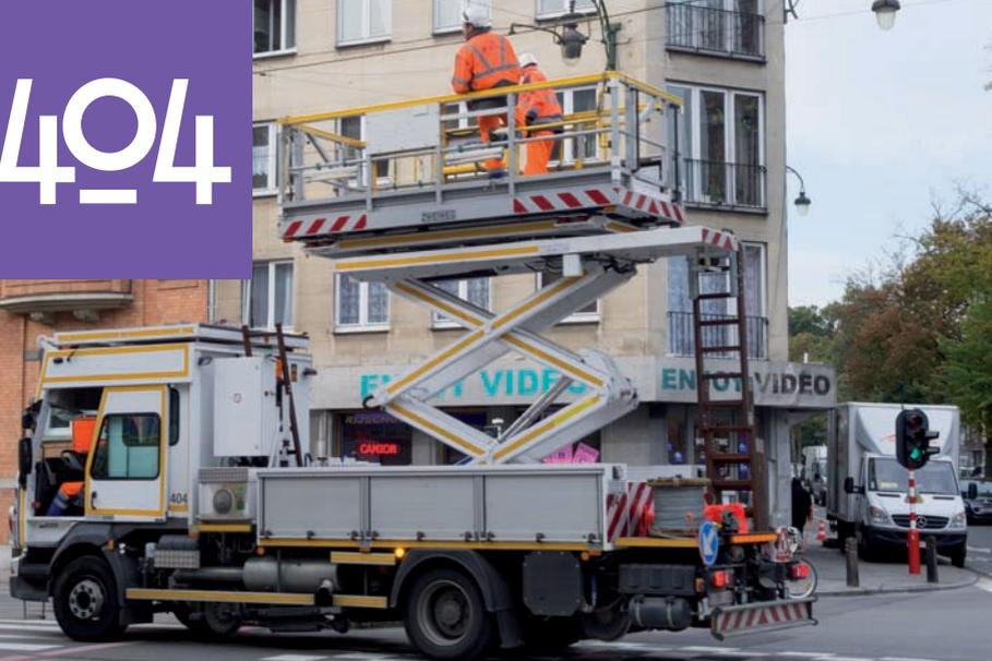
Les véhicules de type 401 à 406 et le 428 sont des voitures-échelles avec une plateforme en double isolation qui sont utilisés pour l'entretien des lignes aériennes (aussi appelées « caténaïres ») du tram en du pré-métro.
