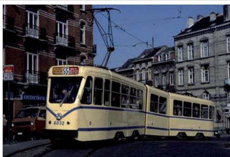
Ce tram est le résultat de la transformation d'anciennes motrices au début des années 1960, tout comme la 9098. Ici il s'agit de l'assemblage de deux châssis de motrices datant des années 1930, reliés entre eux par un élément central fabriqué « sur mesure » et habillés d'une nouvelle carrosserie.
