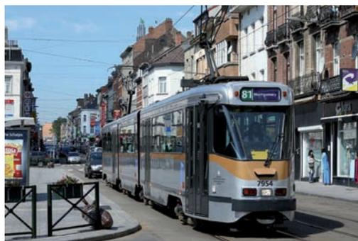
Dans la seconde moitié des années 1970, la STIB achète une troisième et dernière série de tramways PCC à BN (aujourd'hui : Bombardier Bruges) en vue de retirer les derniers véhicules anciens ou convertis et d'augmenter la capacité par véhicule. Ils se distinguent de la série précédente par la caisse supplémentaire, le confort intérieur et le pare-brise légèrement modifié.
