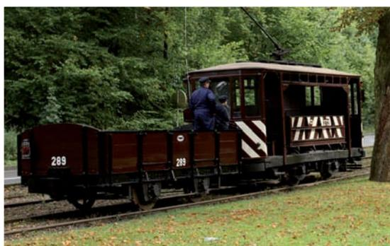
Grâce à sa grande benne basculant latéralement, cette motrice qui a été construite en 1927, peut facilement transporter et décharger des matériaux sur les chantiers de voies (sable, ballast, etc.).
